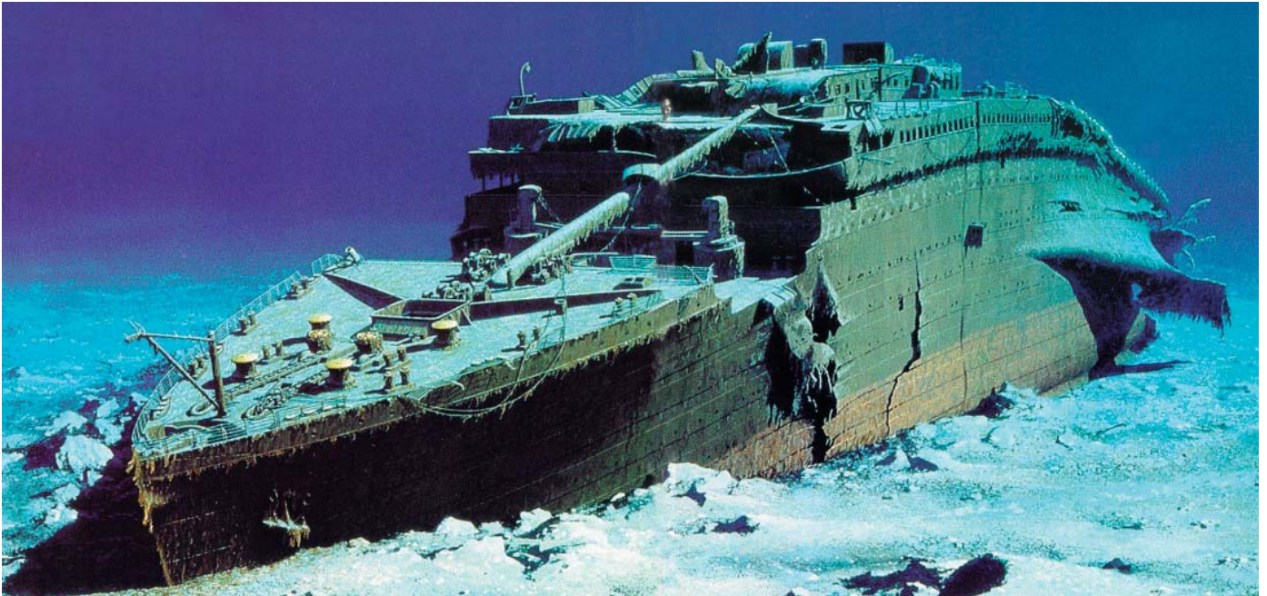
Abb. 16: Bugteil des Wracks. Das Heck befindet sich in einem Abstand von 600 m. Die sechs aufgeplatzten Nähte liegen auf der Steuerbordseite 13 Meter tief im Schlick. Während die Brücke vollständig verschwunden ist, blieb die aus Bronze bestehende Steuersäule des Telemotors unzerstört. Zeichnung von Ken Marshall.
