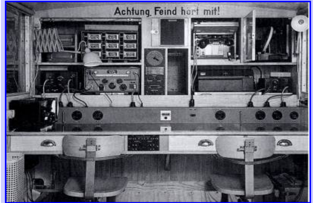
Arbeitsplatz der 1,5kW-Kurzwellenstation (G1,5K), gebaut von der C. Lorenz AG, Berlin, 2. Serie (19423/43) *
